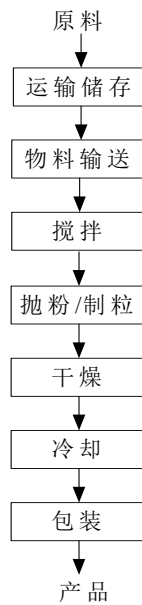
图 3 现有工程生产工艺流程图
